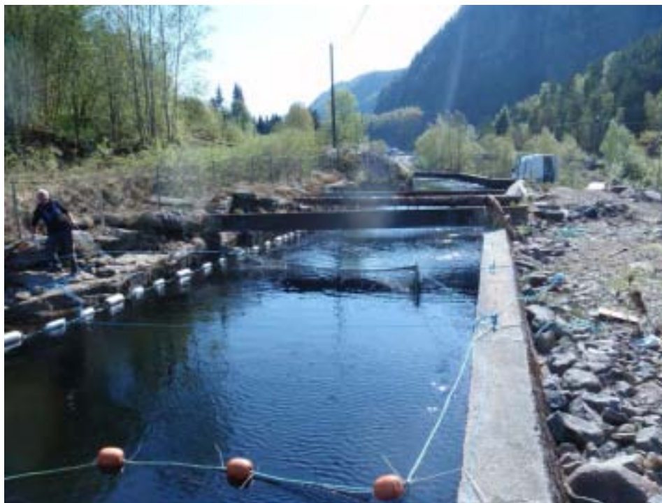
Figur 4. Notpose med stålramme (Fase 2) montert i kanalen. Foto: Å. Johansen/NIVA.
