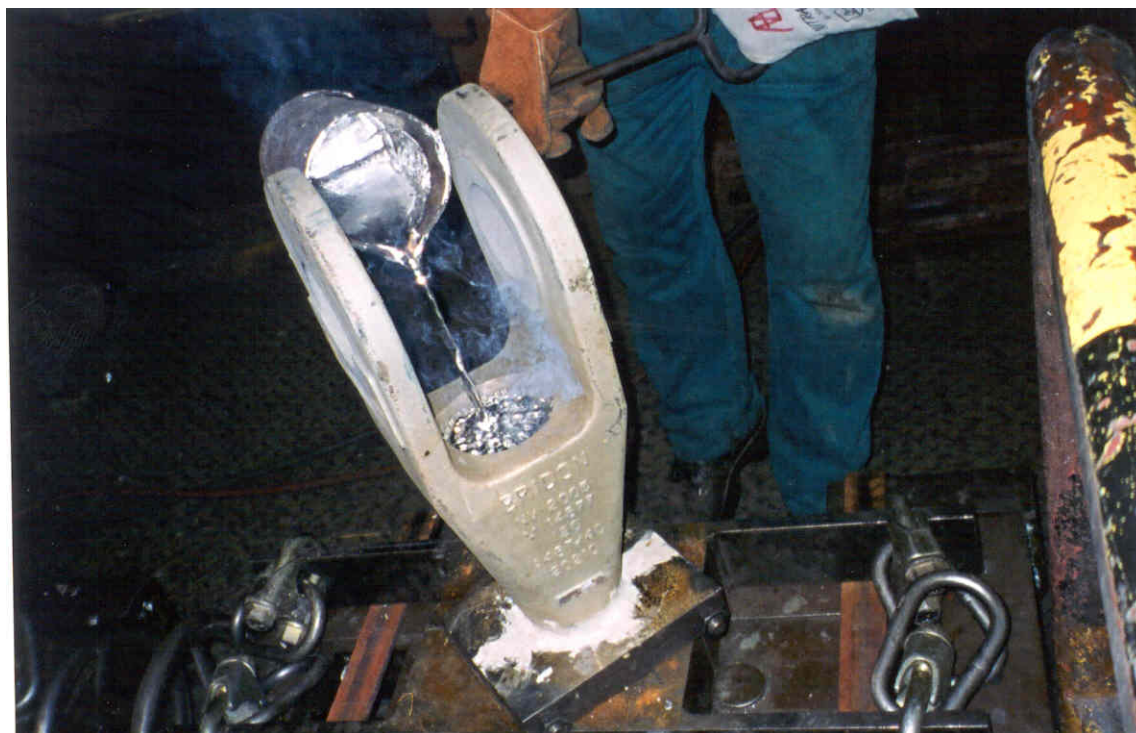
Foto 3. Ihelling av støpemetall, Zamak Z610.
