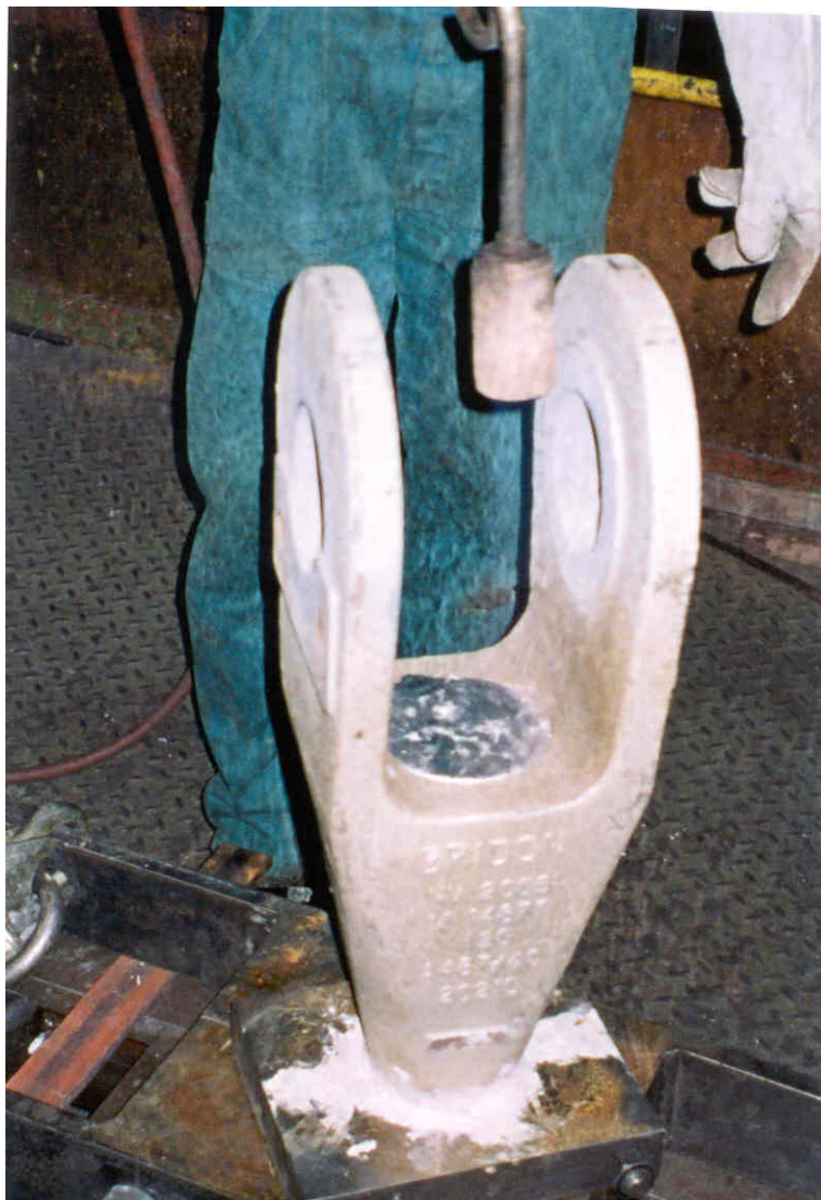
Foto 4. Ettervarming av utstøpt konus.
