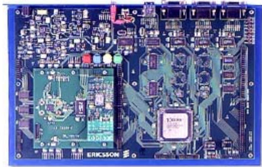
Figur 6 : Ericsson Bluetooth Development Kit. Figuren viser en av totalt to like deler, som igjen kunne kommunisere med hverandre etter installasjon [27]
