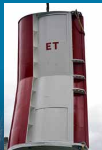
Figur 4: Tråldører med luker som kan åpnes/lukkes for styring av spredning og vertikal- bevegelse under fiske.
