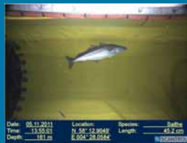
Figur 1: Høgkvalitet fotografering av fisk inni en trål for bestemmelse av størrelse og art.
